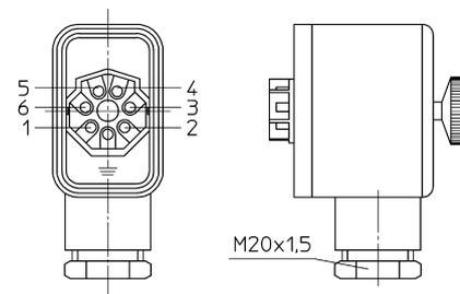
Die genaue Lage der Kabeldurchführung oder des Steckverbinders entnehmen Sie bitte den Datenblättern der jeweiligen Gerätetypen.
