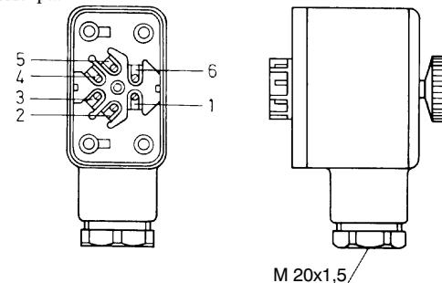
Клеммы кабельной розетки пронумерованы в соответствии со схемой. Кабельная розетка оснащена соединительным элементом с резьбой M20x1,5 и с фиксацией кабеля.
